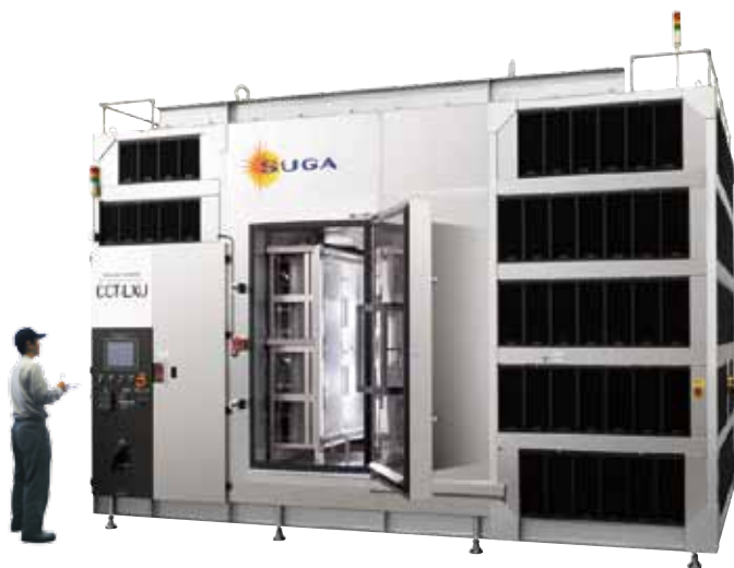
太陽電池モジュール用 (120cm×150cmのモジュールを2枚試験)
